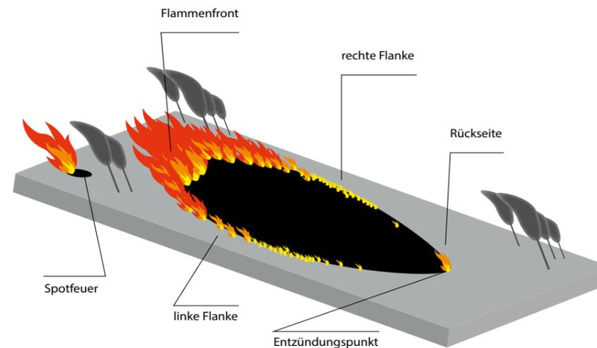
Abbildung 8 mögliche Form eines Vegetationsbrandes
